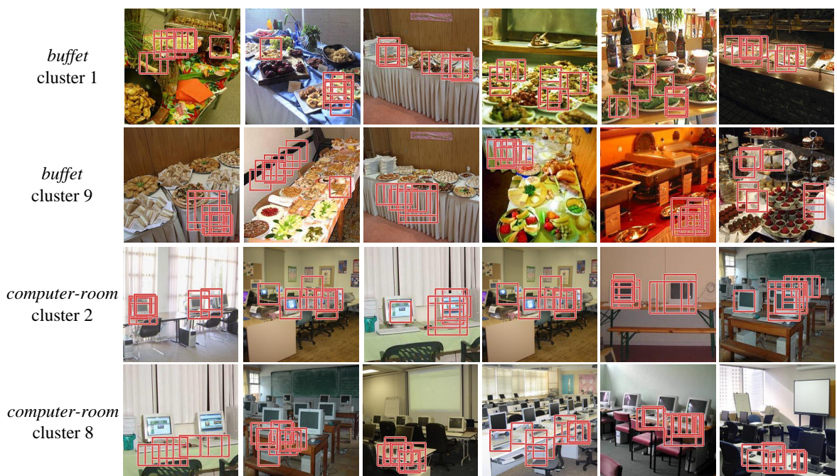
图 5-5 采用MMDL方法在不同类别上学习得到的一些有意义的子类(上图中记为cluster)。每一行展示了一个子类, 红色的方框标注了那些G-code分类器所对应的SVM方程值大于0的图像位置。
